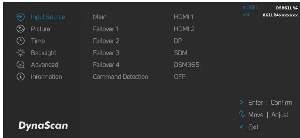
\* Failover とは優先している入力信号が何等かの理由で途絶えた場合にバックアップとして次の信号を再生する為の設定。左の場合はHDMI1信号がメイン、もし信号が来なくなったらHDMI2—DP—DSM365(内蔵メディアプレイヤー)の順で入力のある信号を再生。
