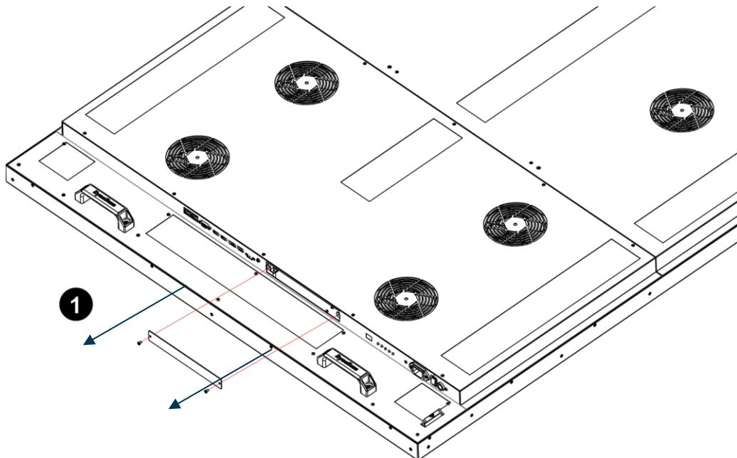
2. SDM PC を挿入しスロットのカバーのネジを締めます。SDM PC が正しく組み込まれていることを確認してください。
