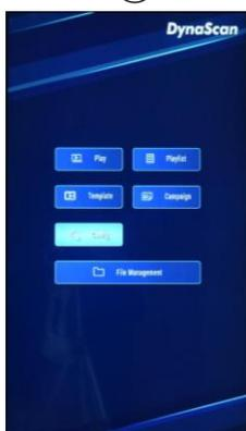
リモコンの上下左右キーを押して“Config”に合わせ(ハイライトになります)、決定を押してください。
